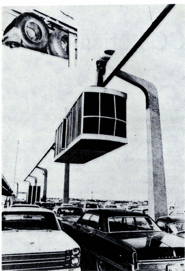
Fra vognen, der ruller på gummihjul (se billedet i venstre hjørne foroven) hejses og sænkes en automatisk elevator.
